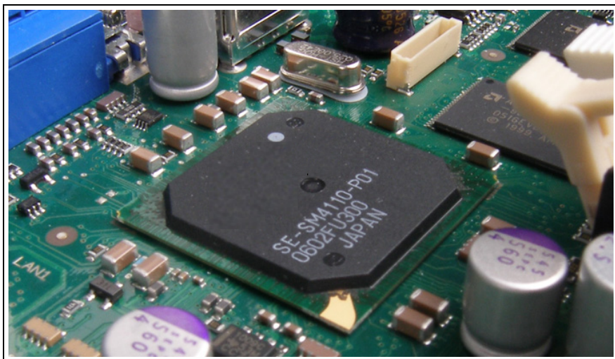
図 1: PRIMERGY サーバのシステムボード上の iRMC S2
